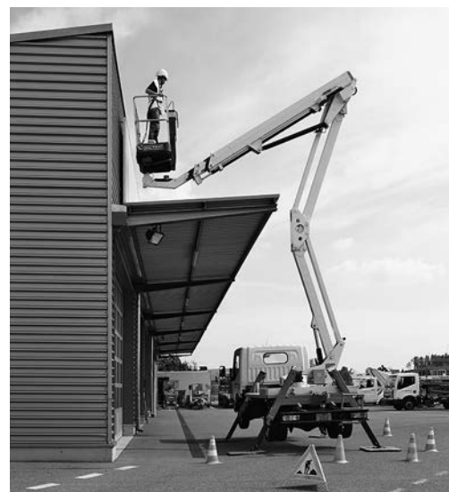
Fig. 4: le lieu d'intervention doit être signalé de manière à ce que les passants ne pénètrent pas dans la zone dangereuse de la PEMP.
